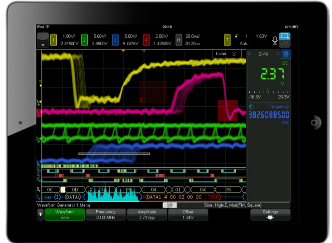
Рисунок 53. Управление осциллографом серии 6000 X с планшетного компьютера.
