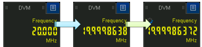
Рисунок 33. С помощью прецизионного 10-разрядного частотомера установлено, что истинная частота тактового сигнала немного меньше 20 МГц.
