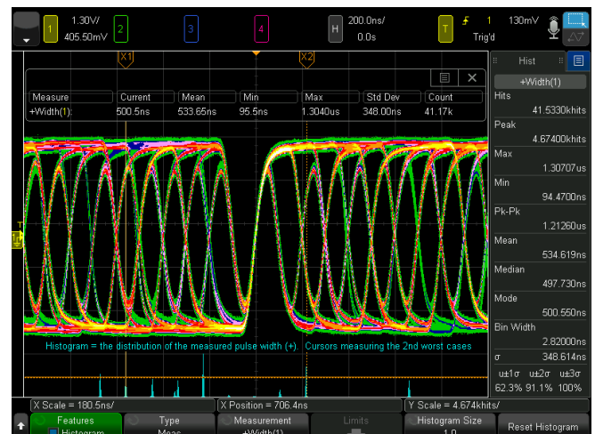
Рисунок 16б. Гистограмма результатов измерения ширины импульса.
