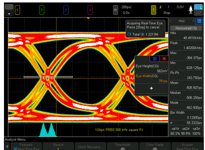
Рисунок 21. Измерение глазковой диаграммы в режиме реального времени встроенного тактового сигнала псевдослучайной двоичной последовательности 1 Гбит/с с джиттером. Гистограмма указывает на бимодальный характер распределения и величину джиттера около 55 пс СКЗ.
