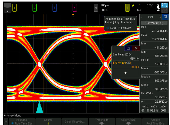
Рисунок 20. Измерение глазковой диаграммы в режиме реального времени чистого встроенного тактового сигнала псевдослучайной двоичной последовательности 1 Гбит/с. Гистограмма указывает на наличие джиттера величиной около 22 пс СКЗ.
